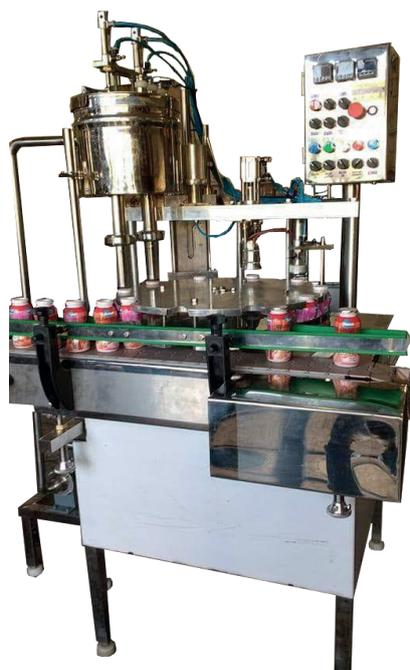
**DESCRIPTIVO:** POSSUI DOIS BICOS DE DOSAGEM. ESTRUTURA TOTALMENTE EM AÇO INOX. DOSA, COLOCA O SELO, SELA E MOLDA.
