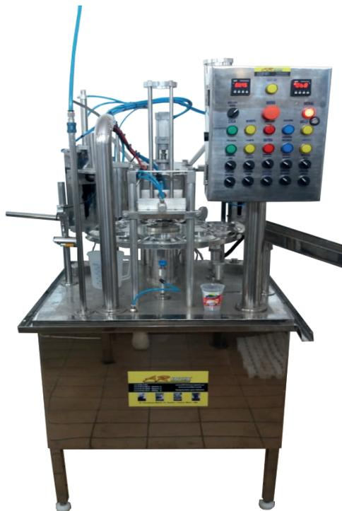
**DESCRIPTIVO:** SISTEMA DE ENVASE E SELAGEM DE EMBALAGENS COM TAMPA DE ALUMÍNIO. A ALIMENTAÇÃO DA EMBALAGEM. DOSAGEM, ALIMENTAÇÃO DO ALUMÍNIO E SELAGEM E A RETIRADA DA EMBALAGEM PRONTA SÃO TOTALMENTE AUTOMÁTICOS, COM APENAS UM OPERADOR PARA ACOMPANHAR E ALIMENTAR TODO O SISTEMA DE PRODUÇÃO.
